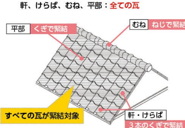
【図】ガイドライン工法（新しい留付け基準）
