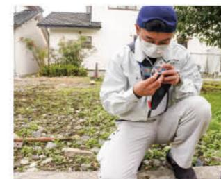
レーザー距離計などでハウスのサイズを計ります。
